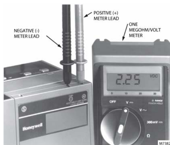
図11: 7800シリーズの燃焼安全制御器における火炎信号電圧の測定
