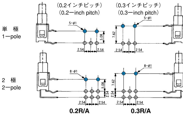
● 端子、ストッパー間のピッチには0.2インチピッチ (5.08mm) と0.3インチピッチ (7.62mm) の2種類がありますので、ご用途によりお選びください。
