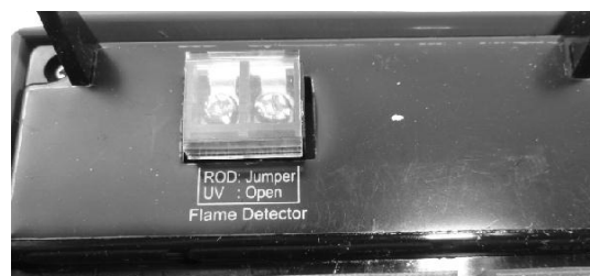
図 4-3: \mu A レンジのマルチメーターでジャックプラグを使ってフレイム信号を測定
